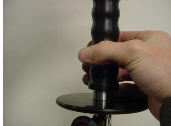
Erleichtern Sie Ihr Handgelenk und machen Sie kleine, präzise Bewegungen mit Ihren Fingerspitzen, der Lift wird sich mit einer langsam-kontrollierbaren Geschwindigkeit bewegen, diese Art von Griff ist gut wenn man Lasten transportieren will, das zu hebende Objekt in Position bringen will usw.
