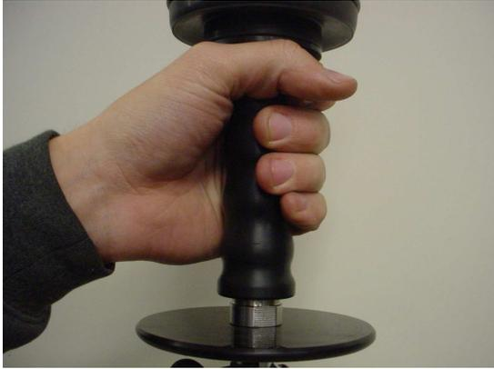
Das Benutzen der ganzen Hand erzeugt große Bewegungen, dadurch eine große Hebegeschwindigkeit des Lift, dieser Art von Griff kann benutzt werden wenn keine Lasten transportiert werden.
